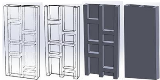
Figure 5. L'élément de base de construction
