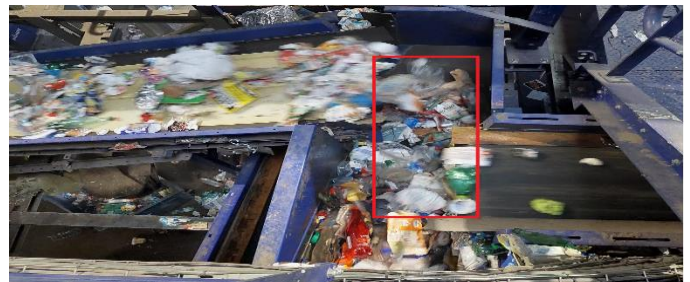
Figure 3. Bourrage (par accumulation de déchets) en cours de formation sur un tapis convoyeur
