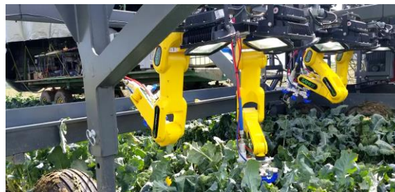
Figure 1. Robots cueilleur et systèmes de vision fixés sur une structure remorquée par le tracteur
